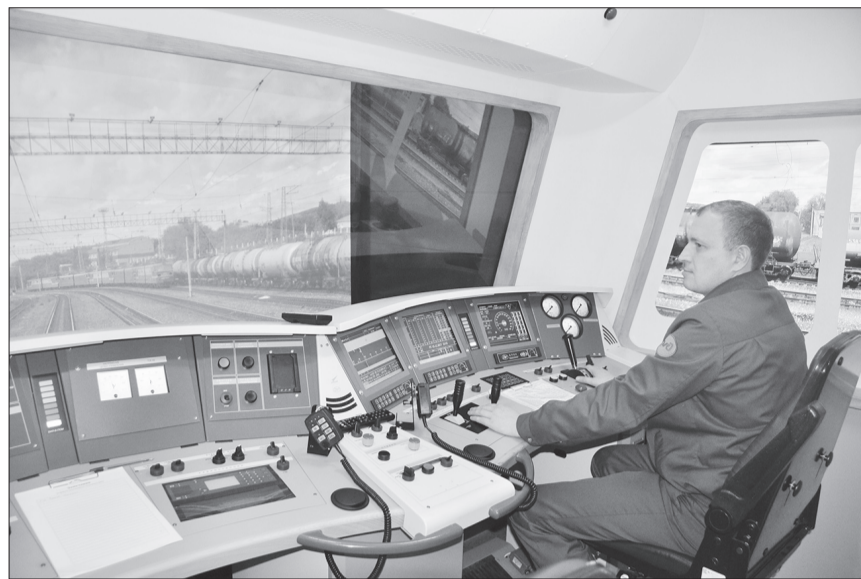
На тренажере можно задать любую рабочую или нештатную ситуацию во время движения локомотива.
