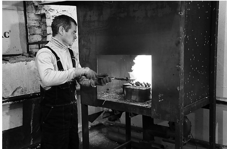
Оборудованная Иваном Терентьевым печь ускорила трудоемкую работу по восстановлению деталей сельхозтехники. У жара пламени специалист справляется с работой.
