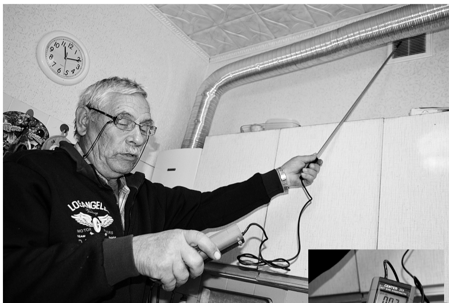
Три раза в год, строго по графику: проверка вентканалов обязательный пункт в перечне задач управляющей компании.
